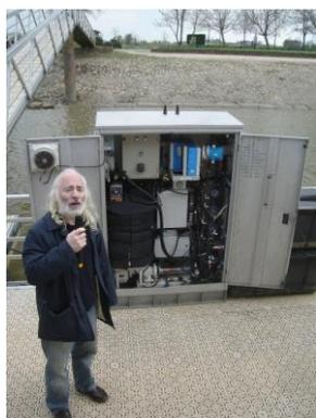
L'objectif du Réseau d'Observation Automatisé de la Gironde est de suivre en continu la qualité des eaux de l'estuaire. Les stations sont équipées pour mesurer en continu l'oxygène dissous, la salinité et la température. Les données recueillies permettront d'acquérir une meilleure connaissance des processus physiques et biologiques liés au bouchon vaseux et de suivre le problème d'oxygénation des eaux à Bordeaux pendant la période estivale.
